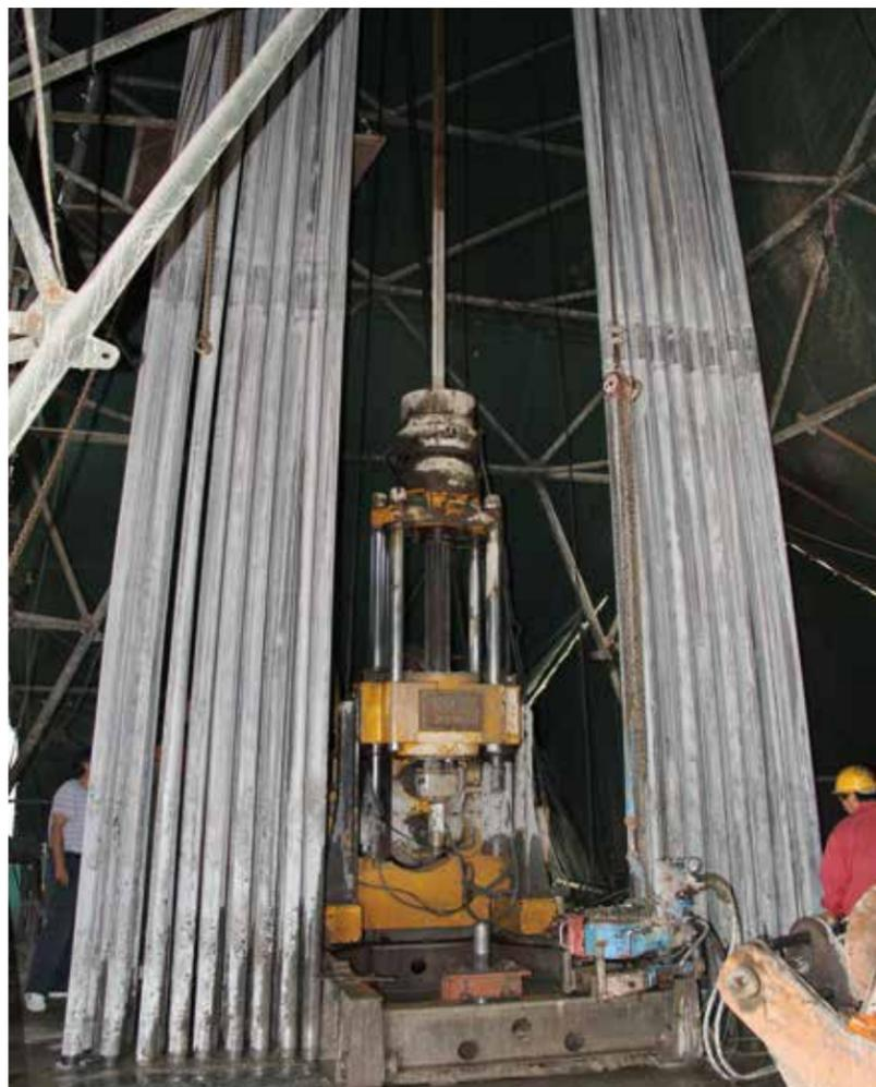
铜陵矿集区 TLZK-01 钻孔采用了先进的绳索取芯钻进工艺。
