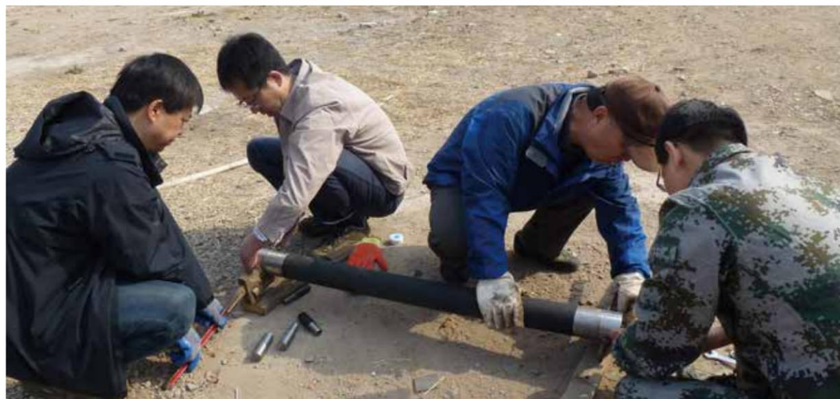
SinoProbe-06 项目组在组装水压致裂地应力测试系统。
